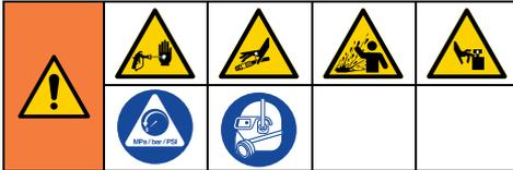
本装置は、圧力が手動で開放されるまでは、加圧状態が続きます。皮膚への侵入、液体の拡散、可動部品など、高圧液体による深刻な損傷を受けないようにするには、スプレーヤーを停止させたときに、スプレーヤーの洗浄または点検を行う前に、および装置のサービス作業を行う前に圧力開放手順を実施します。
