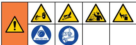
L'apparecchiatura rimane pressurizzata finché la pressione non viene scaricata manualmente. Per evitare gravi lesioni causate dal fluido pressurizzato, come iniezioni nella pelle, dagli spruzzi di fluido e dalle parti mobili, seguire la Procedura di scarico della pressione quando si arresta lo spruzzatore e prima di pulirlo o controllarlo e di eseguire la manutenzione dell'apparecchiatura.
