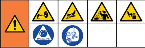
수동으로 감압할 때까지 장비는 계속 가압 상태를 유지합니다. 피부 주입, 유체 튀김 및 움직이는 부품과 같은 가압 유체로 인한 심각한 부상을 방지하기 위해 도장기를 멈추고 도장기를 청소/점검하기 전 및 장비를 정비하기 전에 감압 절차를 실시하십시오.
