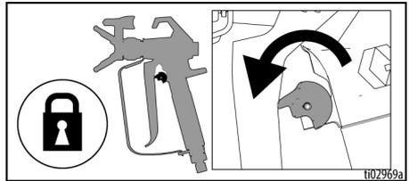
11. 압력 제어장치 노브를 가장 낮은 압력 설정으로 돌리고 ON/OFF 스위치를 **OFF** 위치로 돌립니다. 도자기 전원을 차단하십시오. 프레임 스프레이 밸브를 PRIME(프라임) 위치로 돌립니다.
