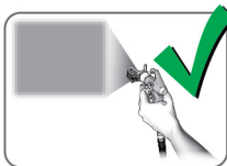
Pulverización con patrón de abanico atomizado y distribuido uniformemente
