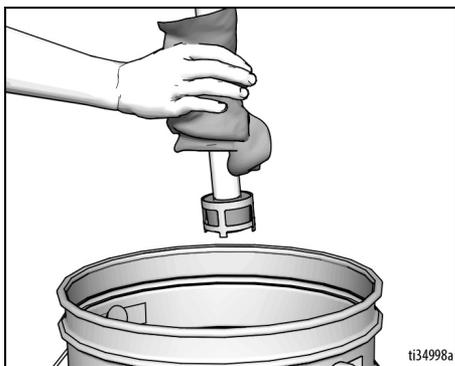
4. 吸引チューブを洗浄液に入れます。水性塗料の場合には水を、油性塗料の場合にはミネラルスピリットを使用します。ドレンチューブを廃液ペール缶の中に入れます。
