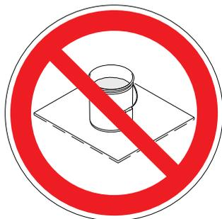
**金属ペール缶は必ず接地してください:** 接地線をペール缶に接続してください。一端をペール缶にクランプし、もう一端を金属製の水道管などの大地アースにクランプしてください。
