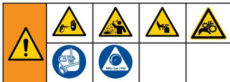
加圧された液体（肌への噴射など）、液体の飛散、可動部品による深刻な負傷の発生を防止するため、スプレー停止後と機器を清掃、点検、および整備する前に、**圧力開放手順**に従ってください。
