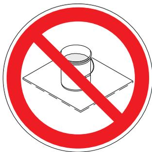
**Metalleimer müssen immer geerdet werden:** einen Erdungsleiter am Eimer anbringen. Ein Ende am Eimer und das andere Ende an eine effektive Erdung wie z. B. ein Wasserrohr aus Metall anbringen.
