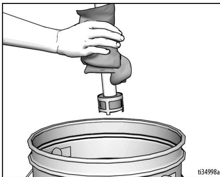
4. 将吸料管放入冲洗液中。水性涂料用水，油性涂料用矿物油精。将排放管放入废液料桶中。
