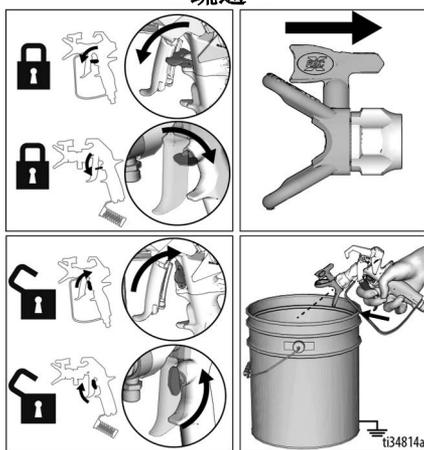
2. 锁上扳机锁。将喷嘴旋转到原始位置。松开扳机锁，继续喷涂。
