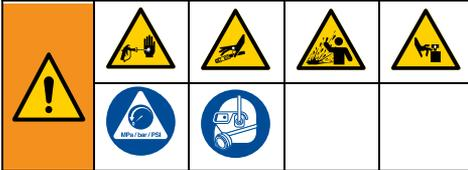
本设备在手动释放压力之前一直处于加压状态。为防止加压流体造成人员重伤（如喷射到皮肤、流体溅泼和零部件移动），每次停止喷涂时和清洗、检查或维修设备前，请按照**泄压步骤**执行。
