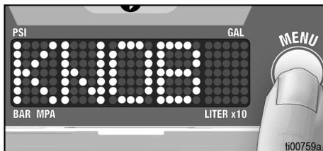
3. 即将进入 TurboClean 之前，将电位计设置到最大喷涂位置。
