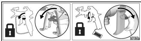
10. 将压力控制旋钮转到“关”位置，并将“开/关”开关转到关位置。切断喷涂机电源。
