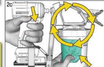
**Hinweis:** Dadurch wird die gesamte Luft aus der Pumpe und dem Becher entfernt. Die Farbe spritzt nicht heraus, sondern zirkuliert durch die Pumpe und zurück in den Becher.
