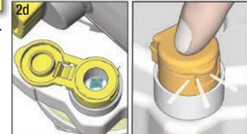
3 Drehen Sie den Ansaugknopf nach vorne in die SPRAY-Position. Vergewissern Sie sich, dass sich die Sprühdüse in der SPRÜH-Position nach vorne befindet.
