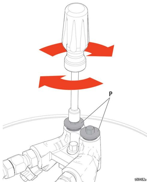
3. Retirer les clapets anti-retour du collecteur (P) en les dévissant du collecteur de fluide.
