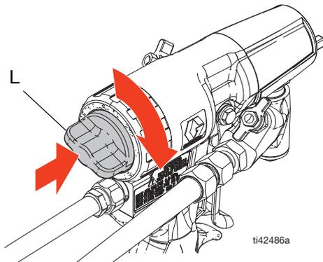
**Pour désenclencher le verrouillage de sécurité du piston :** pousser le verrou de sécurité du piston (L) et le tourner dans le sens inverse des aiguilles d'une montre jusqu'à ce que le bouton s'arrête en position verticale.
