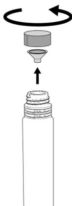
**REMARQUE :** En retirant le bouchon en plastique, s'assurer que le second bouchon en plastique interne est également retiré.
