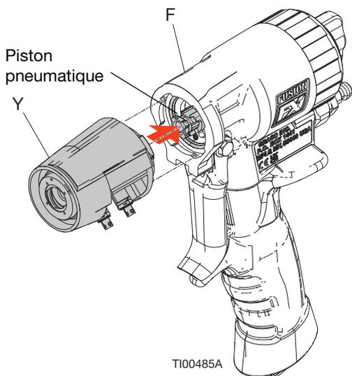
4. Tourner la cartouche de fluide FX (Y) de 1/8 de tour dans le sens des aiguilles d'une montre pour la mettre en position verticale.
