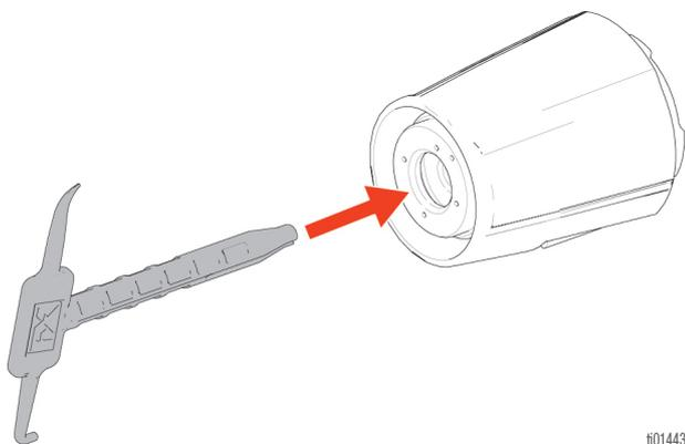
4. Vérifier qu'il n'y a pas d'obstruction sur les sorties côté A et côté B de la cartouche de fluide FX (Y) à l'aide de l'outil de contrôle des obstructions. La cartouche de produit FX est obstruée si l'outil de contrôle n'entre pas dans la sortie du côté A ou B.
