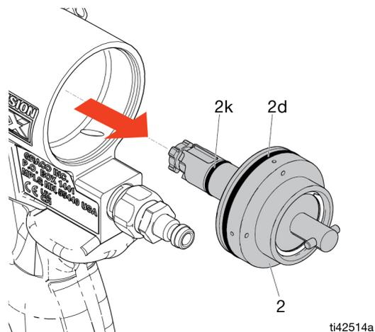
7. Lubrifier généreusement les joints toriques du piston (2d et 2k). Remonter le piston (2). La tige est verrouillée pour un montage correct. Pousser fortement pour mettre le joint d'étanchéité sur le piston.
