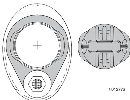
6. Après insertion complète de la cartouche, tourner la cartouche de 1/4 de tour dans le sens des aiguilles d'une montre afin de la verrouiller sur la poignée du pistolet.
