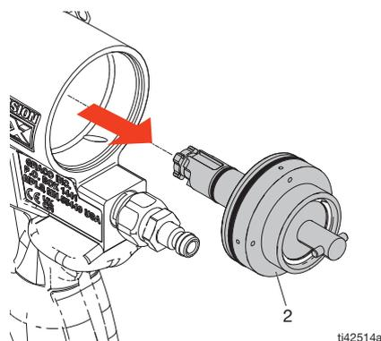
5. S'assurer que les joints toriques (2k) et (2d) sont installés sur le piston de purge d'air et lubrifiés. Installer le piston de purge d'air. La tige de piston est verrouillée pour un montage correct.
