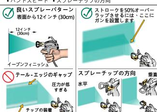
スプレーチップの詰まりが発生した場合は 、スプレーチップを逆にしてウェストエリ アにスプレーし、詰まりを除去してくださ い・スプレーチップをスプレー位置に戻し 、スプレーします。取扱説明書を参照して ください。
