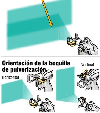
**Orientación de la boquilla de pulverización**
