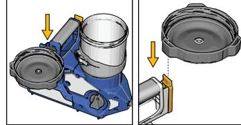
**4** Retire el filtro de la bomba y limpie los residuos de la malla filtrante.
