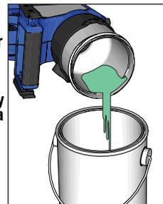
**2** Retire el pulverizador del cinturón de herramientas. Retire la tapa de la copa y vierta la pintura sobrante de nuevo en la lata de pintura.
