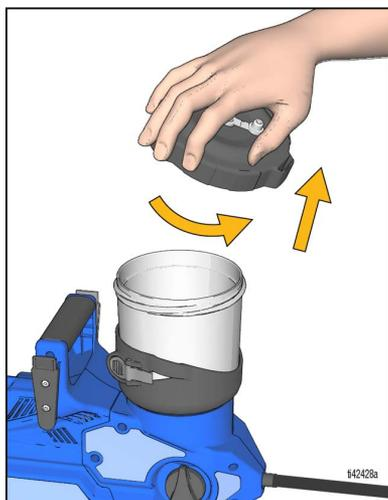
3. ポンプ入口のカップの底にきれいなポンプ フィルターが取り付けられていることを確認します。塗料には黒のフィルターを使用し、染料や薄い素材には青のフィルターを使用します。
