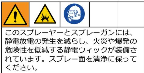
11. スプレーヤーとスプレーガンの静電ウィックを掃除します。
