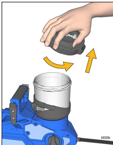
3. Verifique se está instalado um filtro de bomba limpo no fundo do copo, na entrada da bomba. Use o filtro preto com tintas e o filtro azul com colorações e materiais finos.
