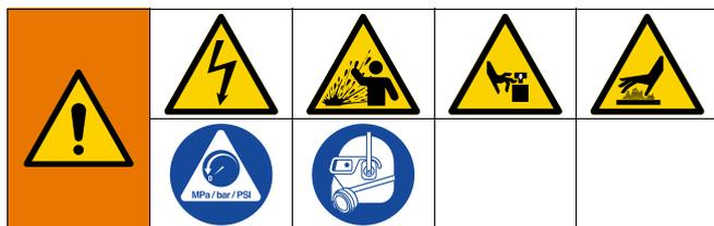
本装置は、圧力が手動で開放されるまでは、加圧状態が続きます。液体の飛散などの加圧状態の液体、および可動部品から生じる重大な怪我を避けるには、操作を停止したときと装置を清掃、点検、および整備する前に、**圧力開放手順**に従ってください。
