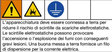
Posizionare il traccialinee in modo che le ruote siano su una superficie con messa a terra efficace. Non sulla pavimentazione.
