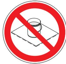
**Les seaux métalliques doivent toujours être mis à la terre** : raccordez un fil de terre au seau. Fixez une extrémité au seau et l'autre extrémité à une véritable prise de mise à la terre, comme une canalisation d'eau.
