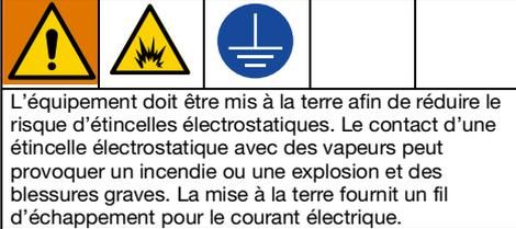
Positionnez le traceur de façon à ce que les roues soient en contact avec une surface véritablement mise à la terre. Pas sur la chaussée.
