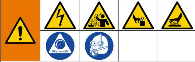
Este equipo seguirá presurizado hasta que se alivie manualmente la presión. Para ayudar a evitar lesiones graves provocadas por fluido presurizado, como salpicaduras de fluido y piezas en movimiento, siga el **Procedimiento de descompresión** cuando deje de trabajar y antes de limpiar, revisar o realizar tareas de mantenimiento en el equipo.
