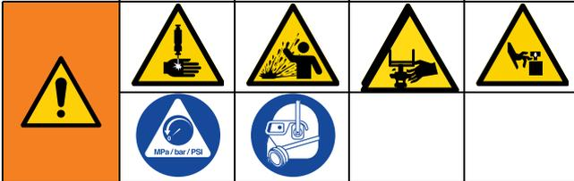
本设备在手动释放压力之前一直处于加压状态。为防止加压流体造成严重伤害，如喷射到皮肤、流体溅泼和部件移动，在停止喷涂时以及清洗、检查或维修设备前，请遵照泄压步骤进行操作。
