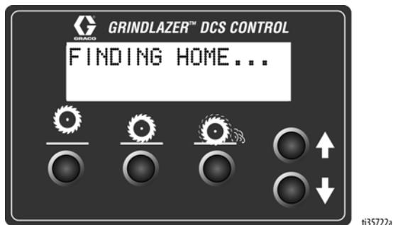
Une fois que la commande DCS revient à la position de début, s'assurer que le modèle sélectionné correspond à l'appareil, ainsi que la langue et les unités de mesure. Se reporter à la section **Écrans de menu**, page 15, pour obtenir des instructions sur la modification de ces paramètres.
