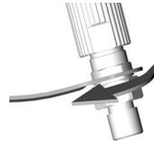
5. Wenn die Ausrichtungskerben nicht mehr miteinander in Eingriff stehen, den Griff mit der Hand drehen und vom Pistolenkopf abnehmen.
