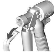
4. Der Abzugsschutz unterhalb des Pistolengriffs kann dann als Schraubenschlüssel zum Lösen der Mutter verwendet werden.
