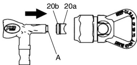
4. Coloque el cilindro de la boquilla (20c) como se muestra. Gire 90° en sentido contrario a las agujas del reloj hacia la posición de rociado, de forma que la flecha apunte hacia delante. Ponga el portaboquillas RAC (19) en la pistola de pulverización.
