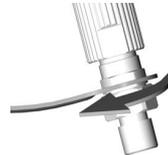
5. Cuando las muescas de alineación ya no estén conectadas, gire la empuñadura con la mano para desmontarla del cabezal de la pistola.
