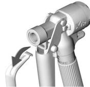
4. El protector de gatillo que hay debajo de la empuñadura de la pistola puede utilizarse luego como llave para aflojar la tuerca.
