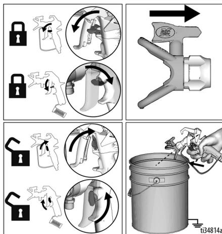
注意：如果喷嘴在旋转至疏通位置时感到难以转动，请执行**泄压流程**，第 18 页，然后将填料/喷涂阀旋转至喷涂位置，然后重复步骤1。
