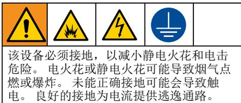
本喷涂机所配电源线具有接地线以及相应的接地插头。
