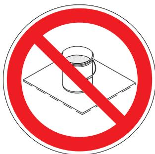
**始终将金属桶接地：**将接地线连接到桶上。将一端固定在桶上，将另一端固定在真正的接地面，例如水管。
