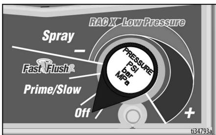
4. 将排料管放入废液桶内并将填料/喷涂阀向下调到填料位置以泄压。
