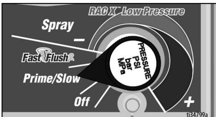
9. Sobald die Spülflüssigkeit aus dem Ablassrohr zu fließen beginnt, den Druckreglerknopf auf „FastFlush“-Einstellung drehen und das Gerät 30 - 60 Sekunden lang spülen lassen.
