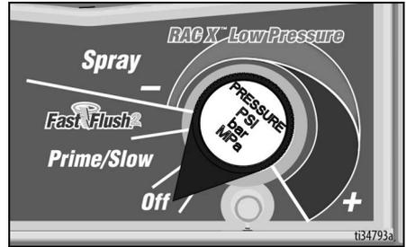
4. Das Ablassrohr in einen Abfalleimer halten und das Entlüftungs-/Spritzventil auf Position **PRIME** (Entlüften) drehen, um den Druck zu entlasten.
