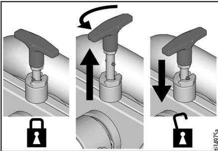
3. Pousser la poignée de l'enrouleur vers le bas et vers l'extérieur. Tourner dans le sens horaire pour enrouler le flexible.
