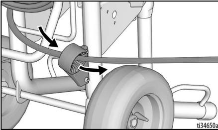
2. Soulever et faire tourner le verrou de pivot à 90° pour déverrouiller l'enrouleur de flexible. Tirer sur le flexible pour le retirer de l'enrouleur de flexible.
