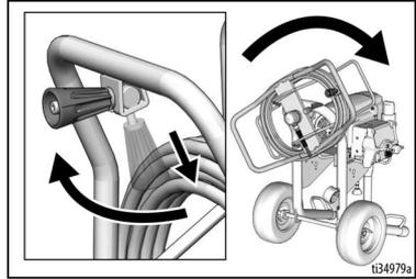
**NOTE :** Le système QuikReel peut être verrouillé dans deux positions : Utilisation (A) et Stockage (B).
