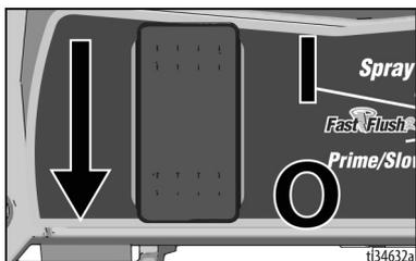
2. Verrouiller la gâchette. Toujours verrouiller la gâchette du pistolet à chaque arrêt du pulvérisateur pour empêcher tout déclenchement accidentel du pistolet pulvérisateur.
