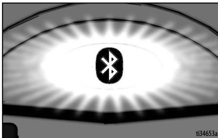
Le nombre de clignotements de la LED correspond au code de l'erreur (par exemple : deux clignotements équivalent au CODE 02).
