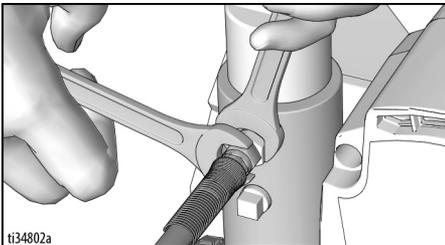
2. Raccorder le pistolet pulvérisateur à l'autre extrémité du flexible. Servez-vous de clés pour le serrer fermement.
