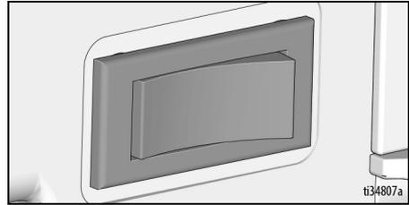
Si un circuit 20 A est disponible, utiliser le réglage 20 A afin d'optimiser les performances du pulvérisateur. Dans le cas contraire, utiliser le réglage 15 A.
