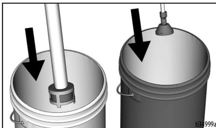
5. Tourner la vanne d'amorçage/rinçage vers le bas vers **AMORÇAGE** pour rincer le tuyau de vidange et la pompe.
