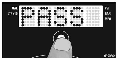
**NOTE :** En cas de défaut d'alignement, le message **FAIL** s'affiche à l'écran, puis le message **KNOB** s'affiche de nouveau. Vérifier que le bouton de réglage de la pression est correctement réglé, puis une nouvelle fois la procédure d'étalonnage.
