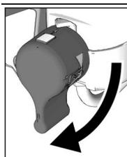
6. Placer le bouton de réglage de la pression sur la position **AMORÇAGE/LENT**, puis placer l'interrupteur **MARCHE/ARRÊT** sur la position **ON** pour démarrer le moteur. Le liquide de rinçage remonte dans le tuyau d'aspiration et sort via le tuyau de vidange au niveau du seau à déchets. Laisser le liquide de rinçage s'écouler du tuyau de vidange pendant 5 secondes.
