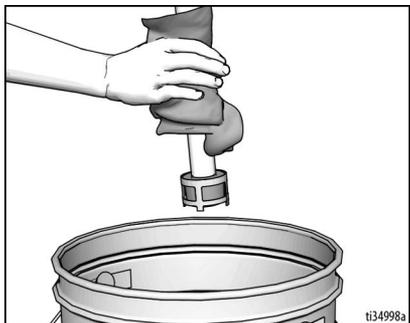
4. Plonger le tuyau d'aspiration dans un liquide de rinçage adapté. Mettre le tuyau de vidange dans le seau à déchets.
