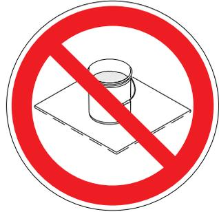
**Siempre conecte a tierra un cubo metálico:** conecte un cable de toma a tierra al cubo. Fije un extremo al cubo y el otro a una puesta a tierra verdadera, como una tubería de agua.
