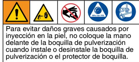
Para evitar daños graves causados por inyección en la piel, no coloque la mano delante de la boquilla de pulverización cuando instale o desinstale la boquilla de pulverización o el protector de boquilla.
