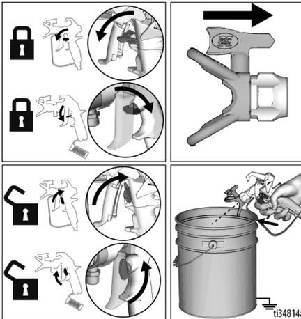
**NOTA:** Si es difícil girar la boquilla de pulverización cuando se gira a la posición de **UNCLOG** (desobstruir), lleve a cabo el **Procedimiento de descompresión**, página 18, luego gire horizontalmente la válvula de cebado/pulverización a la posición **SPRAY** (pulverizar) y repita el paso 1.
