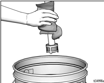
4. Coloque el tubo de aspiración en un fluido de limpieza adecuado. Coloque el tubo de drenaje en un cubo de desechos.
