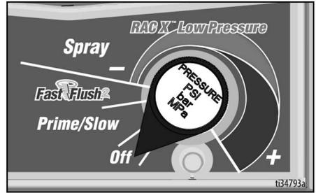
4. Coloque el tubo de drenaje en un cubo de desechos y baje la válvula de cebado/pulverización a la posición **PRIME** (cebado) para aliviar la presión.
