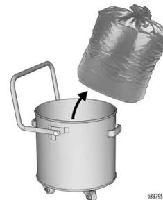
7. Coloque nuevas bolsas en los depósitos de recogida e introduzca el soporte de la bolsa de recogida en la parte superior de la bolsa. A continuación, vuelva a colocar el depósito en el separador Cyclone y en el fondo del LazerVac. Asegúrese de que el depósito de recogida de polvo esté correctamente acoplado en el cuerpo del aspirador presionando hacia abajo la palanca de acoplamiento.
