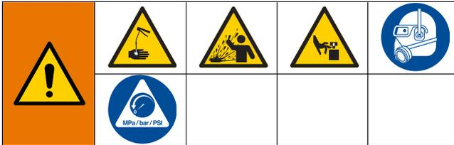
Este equipo seguirá presurizado hasta que se alivie manualmente la presión. Para ayudar a evitar lesiones graves por fluido presurizado tales como inyección en la piel y salpicaduras de fluido, así como las ocasionadas por piezas en movimiento, siga el Procedimiento de descompresión cuando deje de dispensar y antes de limpiar, revisar o realizar tareas de mantenimiento en el equipo.
