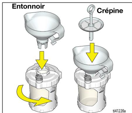
4. Le tuyau d'air de la crépine empêchera la peinture de déborder du réservoir. Remplissez le réservoir comme suit :
