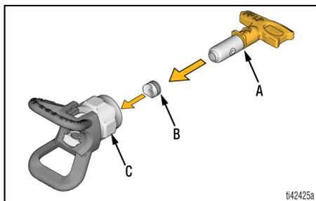
4. Insérez la buse de pulvérisation. La buse de pulvérisation doit être enfoncée complètement dans le garde-buse.
