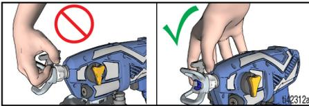
Ajustez le garde-buse de la buse de pulvérisation dans la direction de pulvérisation verticale ou horizontale voulue.
