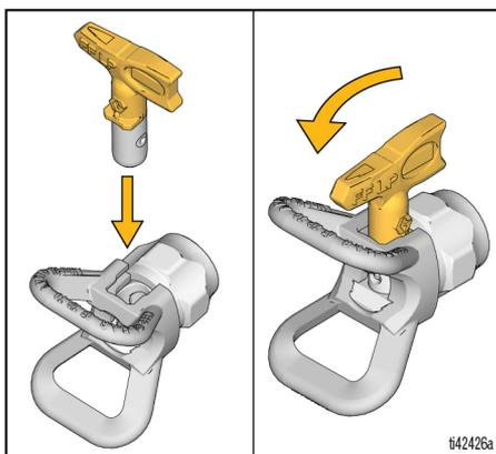
5. Visser l'assemblage du garde-buse sur le pulvérisateur et serrer à la main.
