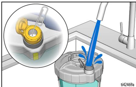
**REMARQUE :** Veillez à nettoyer l'intérieur du réservoir de la VacuValve. Si l'orifice d'air de la VacuValve se bouche, utilisez un trombone pour le nettoyer.
