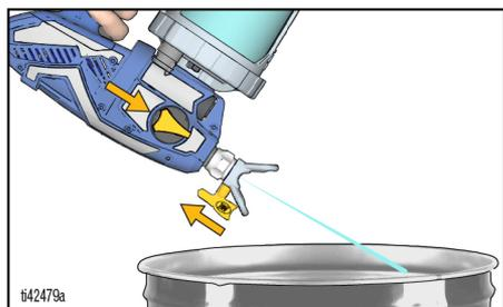
9. Tournez la vanne d'amorçage en position PRIME (Amorçage) pour relâcher la pression du système et remettez-la immédiatement en position SPRAY (Pulvérisation) pour le stockage. Débranchez le cordon d'alimentation.
