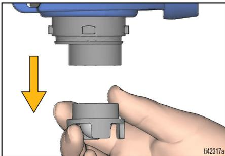
3. Réinstallez le filtre de pompe dans la pompe. Posez le pulvérisateur sur un chiffon.
