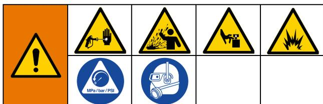
Este equipamento permanece pressurizado até que a pressão seja aliviada manualmente. Para ajudar a evitar lesões graves devidas ao fluido pressurizado, como injeção na pele, respingos de fluidos e partes móveis, siga o Procedimento de alívio da pressão quando parar de pintar e antes da limpeza, verificação ou manutenção no equipamento.
