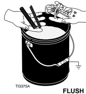
5. Coloque o conjunto do tubo sifão no balde metálico aterrado preenchido parcialmente com líquido de lavagem. Conecte o fio terra ao terra real. Realize a **Inicialização**, etapas 10 - 17 (ver a página 13) para remover a tinta do pulverizador. Use água para remover tintas à base de água e álcool mineral solvente (também chamado de white spirit) para remover tintas à base de óleo. Realize esta etapa para as duas bombas dos pulverizadores 200DC.
