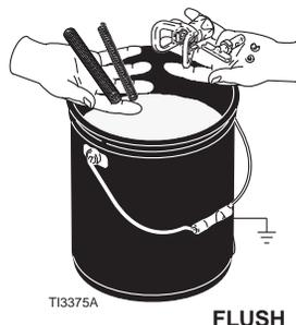
5. 洗浄用液体がある程度入っている接地済みの金属缶にサイフォンチューブを入れます。接地用ワイヤを実際のアースグラウンドに接続します。始動の手順 10-17 ( ページ 13 を参照 ) を実行して、スプレーヤーの塗料を洗浄します。水を使用して水性ペンキの洗浄を行い、ミネラルスピリット溶剤 ( ホワイトスピリットとも言う ) を使用して油性ペンキの洗浄を行います。この手順を 200DC スプレー装置の両方のポンプに実施します。
