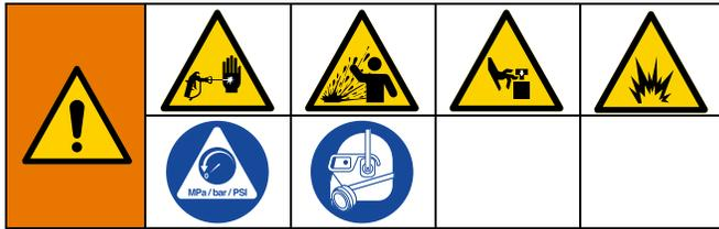
本装置は、圧力が手動で開放されるまでは、加圧状態が続きます。皮膚の貫通などの加圧状態の流体、流体の飛散、および可動部品から生じる重大な怪我を避けるには、スプレー停止後と装置を清掃、点検、および整備する前に、圧力開放手順に従ってください。
