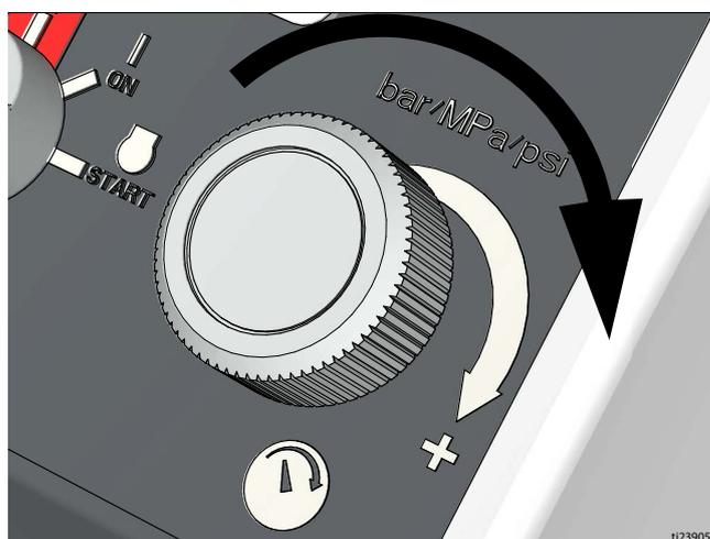
5. Ruotare la regolazione della pressione della pompa idraulica in senso orario finché non sono posizionate, quindi in senso antiorario di 1/6 di giro.
