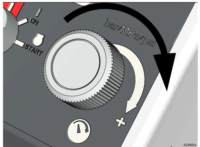
5. Die Hydraulikdruckregelung der Pumpe bis zum Anschlag im Uhrzeigersinn drehen, anschließend 1/6 Drehung gegen den Uhrzeigersinn.
