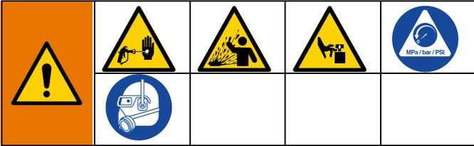
수동으로 감압할 때까지 장비는 계속 가압 상태를 유지합니다. 피부 주입, 유체 튀김 및 부품 움직임과 같이 가압된 유체로 인한 증상을 방지하려면 분배 작업을 중단할 때, 그리고 장비를 세척, 점검 또는 수리하기 전에 감압 절차를 수행하십시오.
