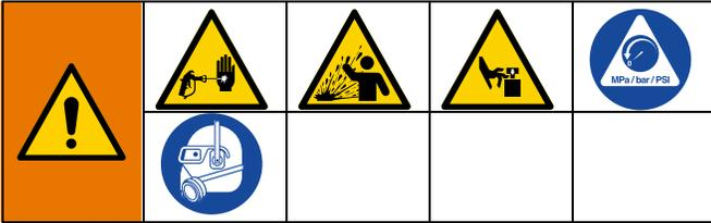
수동으로 감압할 때까지 장비는 계속 가압 상태를 유지합니다. 피부 주입, 유체 튀김 및 부품 움직임과 같이 가압된 유체로 인한 증상을 방지하려면 분배 작업을 중단할 때, 그리고 장비를 세척, 점검 또는 수리하기 전에 감압 절차를 수행하십시오.
