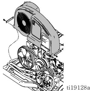
5. 가압 비드 시스템이 장착된 경우 가압 비드 탱크 및 압축기를 설치합니다. 가압 비드 시스템 설명서 332230 을 참조하십시오.
