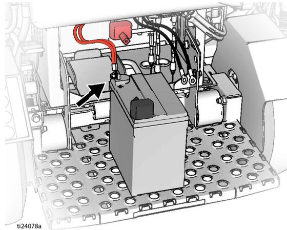
2. 배터리를 집어서 장착 위치에 밀어 넣습니다. 배터리 고정 스트랩을 설치합니다.
