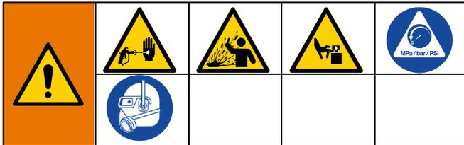
수동으로 감압할 때까지 장비는 계속 가압 상태를 유지합니다. 피부 주입, 유체 튀김 및 부품 움직임과 같이 가압된 유체로 인한 중상을 방지하려면 분배 작업을 중단할 때, 그리고 장비를 세척, 점검 또는 수리하기 전에 감압 절차를 수행하십시오.
