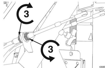
8. 전방 휠이 자동으로 중심에 놓이고 스티어링이 팽팽하고 잘 반응하는지 확인합니다. 볼 조인트 (40) 가 볼에서 쉽게 회전해야 합니다. 필요한 경우, 포크에서 볼 조인트를 제거하고 케이블 (48) 의 볼 조인트를 조절합니다.
