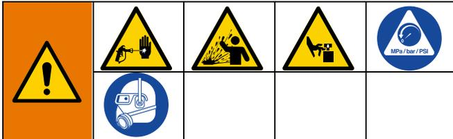
수동으로 감압할 때까지 장비는 계속 가압 상태를 유지합니다. 피부 주입, 유체 튀김 및 부품 움직임과 같이 가압된 유체로 인한 중상을 방지하려면 분배 작업을 중단할 때, 그리고 장비를 세척, 점검 또는 수리하기 전에 감압 절차를 수행하십시오.
