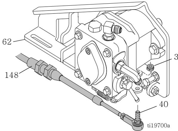
3. 케이블 (148) 을 핸들바 브래킷에 설치하고 너트 2 개를 조입니다. 볼 조인트 (40) 를 케이블 위에 설치합니다. 볼 조인트를 핸들바 정방향 / 역방향 레버에 설치하고 잠금 너트 (3) 를 조입니다.
