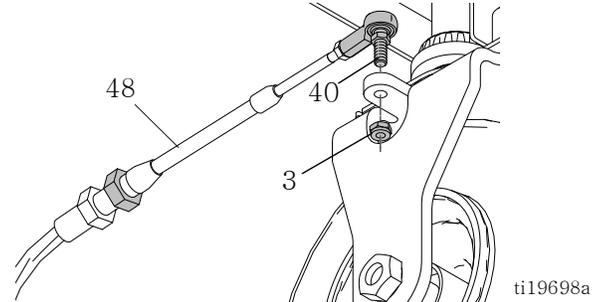
6. 케이블 (48) 의 위치를 기록하고 케이블을 프레임에 고정하는 모든 케이블 타이를 잘라냅니다. 이전 케이블이 제거되었으므로 새 케이블을 설치하여 프레임으로 통하는 동일한 경로를 따릅니다.
