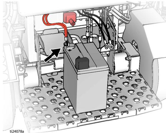
2. 배터리를 집어서 장착 위치에 밀어 넣습니다. 배터리 고정 스트랩을 설치합니다.
