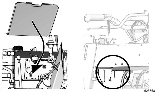
8. 用六个螺丝安装控制护罩。请参见**拆卸**第 6 步。
