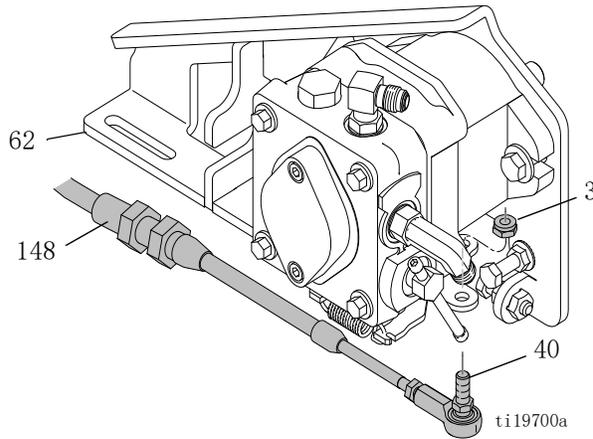
3. 将线缆 (148) 安装到把手支架中，拧紧两个螺母。将球形接头 (40) 安装到线缆上。将球形接头安装到把手前进 / 后退杆中，拧紧锁紧螺母 (3)。
