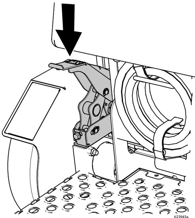
4. 在把手处，从把手上卸下锁紧螺母 (3) 和球形接头 (40)。从线缆 (48) 上取下球形接头 (40)，如不更换，则保管好。松开线缆 (48) 上的两个螺母，从支架上取下。
