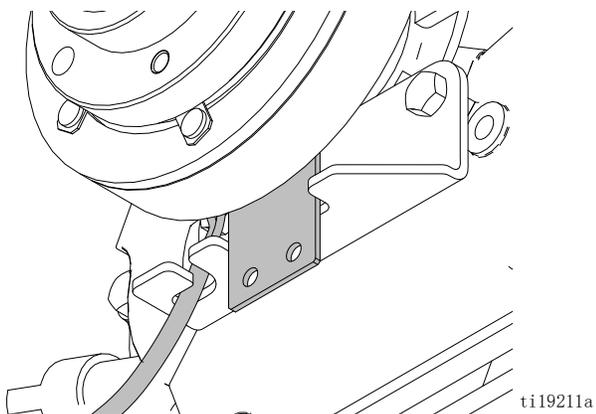
3. 将重型垫圈 (58) 和螺栓 (59) 安装在曲轴上。将螺栓拧紧至 45 +/- 5 英尺磅 (61 +/- 7 牛·米)。使用反冲起动杯中的螺丝刀固定住曲轴。
