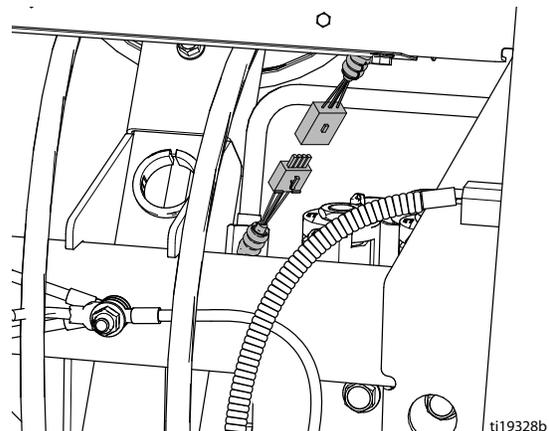
5. 使用扳手下螺丝 (6)、销夹 (5) 和车轮传感器 (4)。
