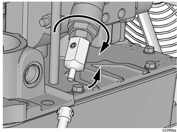
6. 安装电缆，拧紧两个定位螺丝。
