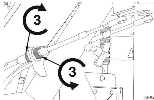
8. 验证前轮是否自动定心，以及转向电缆是否绷紧有效。球形接头 (40) 应能够在球上自如转动。如有需要，从叉上取下球形接头，调节线缆 (48) 上的球形接头。
