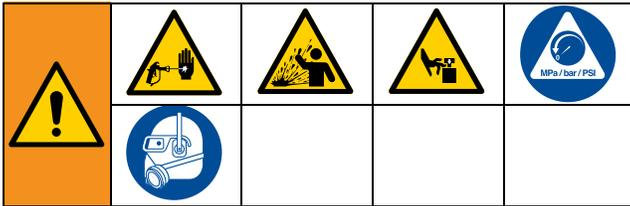
本设备在手动释放压力之前一直处于加压状态。为防止加压流体（皮肤溅射、流体喷洒和零部件移动）带来的重伤，在停止分注和清洗、检查或维修设备之前时，请执行泄压步骤。
