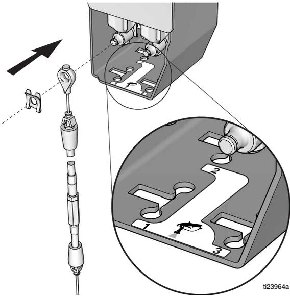
5. 将喷枪电缆连接到执行机构。
