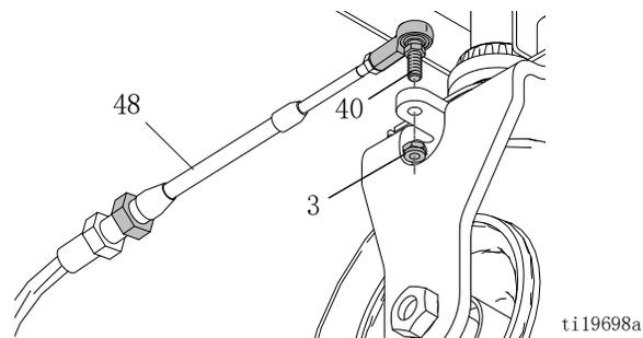
6. 注意线缆 (48) 的位置，切断将线缆固定在机架上的所有束线带。参照取下旧线缆的过程安装新线缆。
