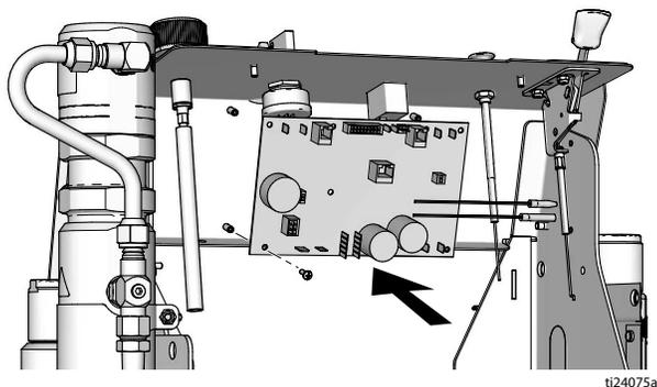
2. 在将引线连接至控制板之前，确保所有引线布置在两个转向电线上方。
