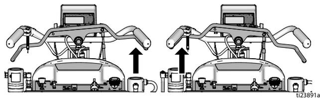
**注释：**两个后轮转动的方向都应正确。如果有一个轮不转动，小心地阻止转动的车轮，清洗不转动的车轮。
