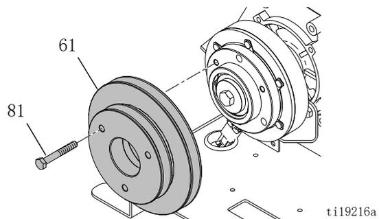
5. 将反冲起动器安装到发动机上。
