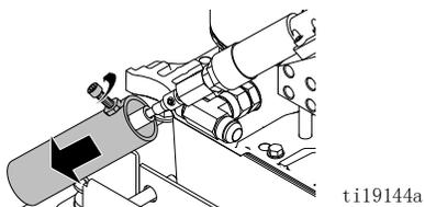
5. 松开两个定位螺丝和电缆。
