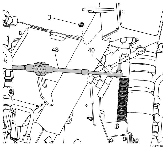
5. 在前轮叉处，从轮叉上取下锁紧螺母 (3) 和球形接头 (40)。从线缆 (48) 上取下球形接头 (40)，如不更换，则保管好。松开线缆 (48) 上的两个螺母，从支架上取下。
