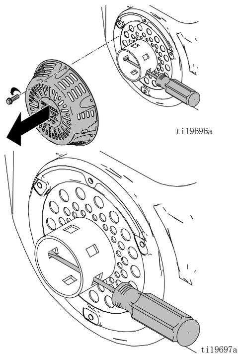
8. 卸下中心螺栓 (59)，再卸下离合器 (57)。
