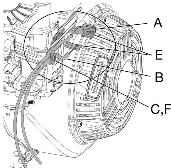
3. 将八根电线连接到发动机。安装继电器支架 (485) 和继电器 (486)。
