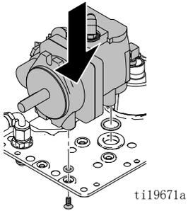
2. 如果油箱中的液压油被污染，排空油箱，去掉污染物。用八个螺丝将油箱盖安装到油箱座上。
