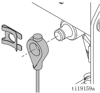
6. 将三条线束连接到螺线管。
