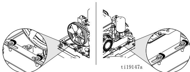
2. 松开两个调整螺栓，将滑轮拉到一起，使皮带松弛。
