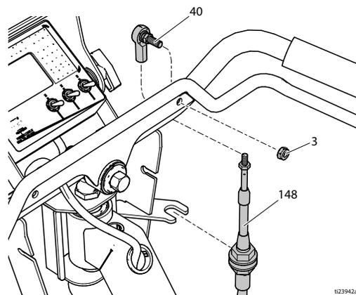
7. 在接地驱动泵处，从接地驱动泵上取下锁紧螺母 (3) 和球形接头 (40)。从线缆上取下球形接头，如不更换，则保管好。松开线缆 (148) 上的两个螺母，从支架 (62) 上取下。
