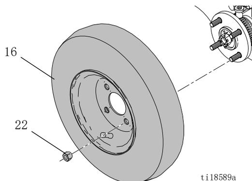
3. 卸下销针 (56)、槽顶螺母 (21b) 和轮毂 (22b)。卸下轮毂可能需要使用卸轮器，Graco 不提供卸轮器。
