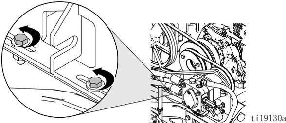
4. 松开拉紧螺栓，将两个滑轮拉到一起，使皮带松弛。
