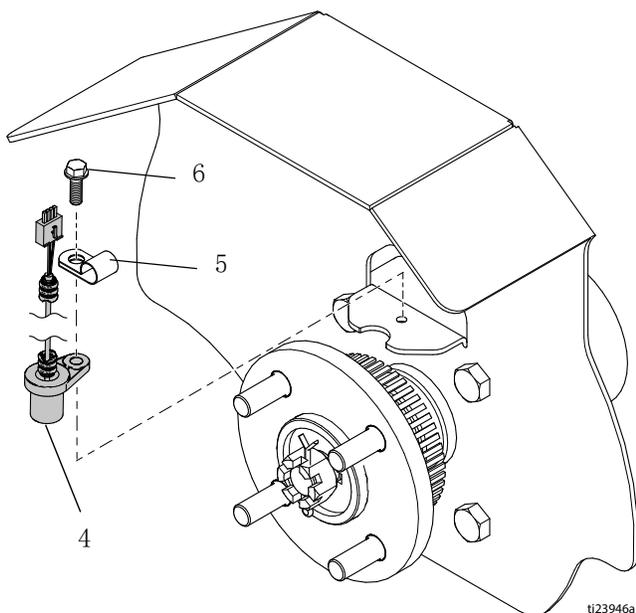
4. 按喷枪扳机控制按钮，用手转动轮毂整三圈。
