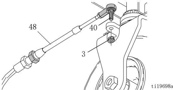
4. 在把手处，调整线缆 (48) 上的前螺母，以匹配把手另一侧的螺纹。将线缆 (48) 安装到支架中，拧紧后螺母。
