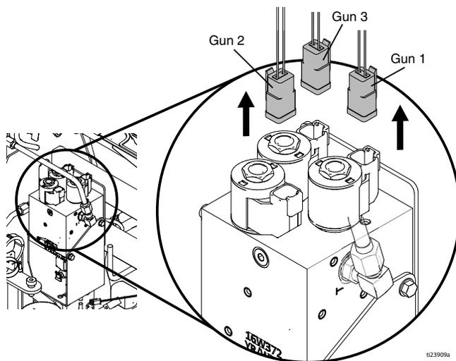
6. 将喷枪电缆标记为 GUN 1、GUN 2 和 GUN 3。断开喷枪电缆与执行机构的连接。
