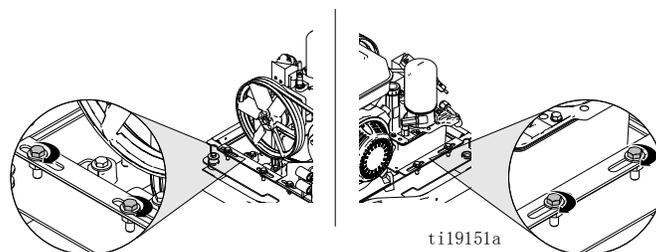
4. 安装**接地传动皮带**，使用适当的扭矩拧紧，请参见**更换接地传动带**，第 10 页。
