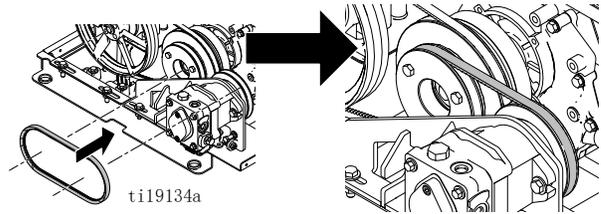
2. 拧紧拉紧螺栓，将两个滑轮分开，以适当的扭矩拧紧皮带（见表）。
