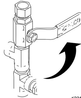
3. 将压力控制旋钮调到最低设置。扣动所有喷枪的扳机进行泄压。
