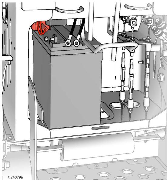
5. 抬起电池，将电池再滑到平台上。断开两条红色引线与电池的连接。
