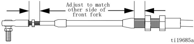
3. 将球形接头 (40) 安装到线缆 (48) 上，匹配前叉另一侧的螺纹。将球形接头 (40) 安装到前叉中，拧紧锁紧螺母 (3)。
