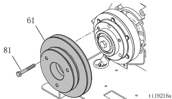
7. 卸下发动机反冲起动器，将螺丝刀放入反冲起动杯。
