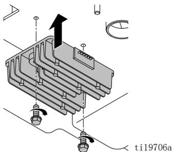
2. 安装发动机，拧紧四个固定螺栓和螺母。
