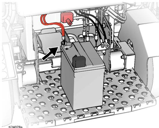
2. 抬起电池将其滑到安装位置。安装电池的压紧带。
