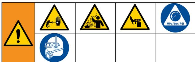
本设备在手动释放压力之前一直处于加压状态。为防止加压流体（皮肤溅射、流体喷洒和零部件移动）带来的重伤，在停止分注和清洗、检查或维修设备之前时，请执行泄压步骤。
