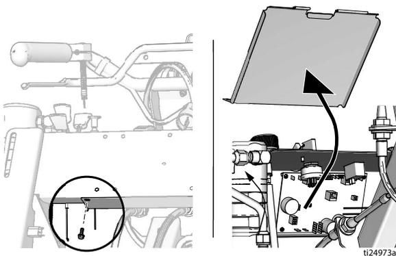
8. 断开控制板上的所有引线。
