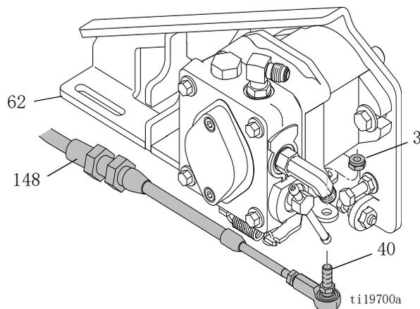
8. 参照取下旧线缆的过程安装新线缆 (148)。
