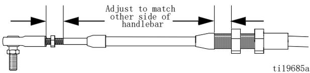
5. 将球形接头 (40) 安装到线缆 (48) 上，匹配把手另一侧的螺纹。将球形接头 (40) 安装到把手上，拧紧锁紧螺母 (3)。
