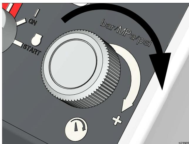
5. Gire hacia la derecha el control de presión de la bomba hidráulica hasta que quede asentado; entonces, gírelo hacia la izquierda 1/6 de vuelta.
