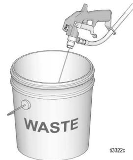
8. ガンを廃液ペール缶のところにもって行きます。バケツに向かってガンを構え、装置全体のフラッシングが完了するまで引き金を引き続けます。
