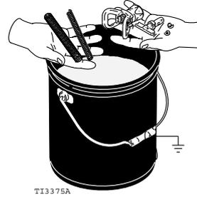
6. 洗浄液がある程度入っている接地されたペール缶にサイフォンチューブを入れます。接地用ワイヤを実際のアースグラウンドに接続します。始動手順11 - 17 (12ページを参照) を実施してスプレーヤー内の塗料の洗浄を行います。水を使用して水性塗料の洗浄を行い、ミネラルスピリット溶剤 (ホワイトスピリットとも言う) を使用して油性ペンキの洗浄を行います。
