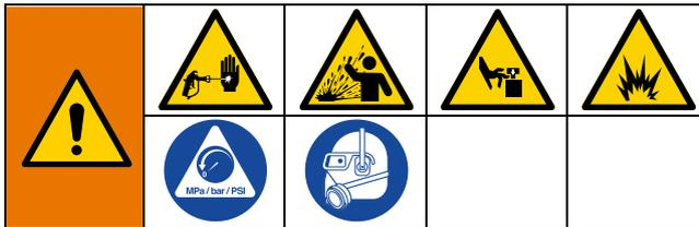
Este equipo seguirá presurizado hasta que se alivie manualmente la presión. Para ayudar a evitar lesiones graves por fluido presurizado, como la inyección en la piel, salpicaduras de fluido y las ocasionadas por piezas en movimiento, siga el Procedimiento de descompresión cuando deje de pulverizar y antes de limpiar, revisar o realizar tareas de mantenimiento en el equipo.
