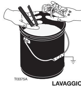
5. Mettere il tubo del sifone in un secchio metallico collegato a terra riempito parzialmente con fluido di lavaggio. Collegare il filo di messa a terra a una presa di terra efficace. Eseguire i passaggi di avvio 10 - 17 (vedere pagina 14) per lavare via la vernice all'interno dello spruzzatore. Utilizzare dell'acqua per lavare via la vernice a base acquosa e dell'acqua ragia per quella a base oleosa.
