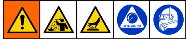
Dieses Gerät bleibt unter Druck, bis der Druck manuell entlastet wird. Um ernsthafte Verletzungen durch das unter Druck stehende Material, wie z. B. Spritzer, zu vermeiden, das Verfahren zur Druckentlastung befolgen, sobald der Spritzvorgang abgeschlossen ist sowie vor der Reinigung, Prüfung oder Wartung des Geräts.
