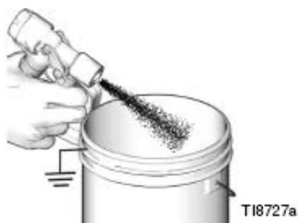
**NOTA:** se si utilizza una pistola AA, ruotare il regolatore della pistola in senso orario per aumentare la pressione dell'aria.
