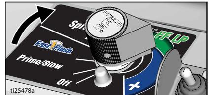
5. Während des Spritzens den Materialdruck reduzieren, bis im Spritzbild Ausläufer sichtbar werden.
