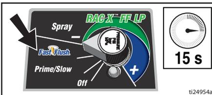
6. Entlüftungsventil waagrecht drehen. Abzugssperre entriegeln.
