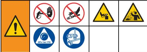
Dieses Gerät bleibt unter Druck, bis der Druck manuell entlastet wird. Um schwere Verletzungen durch unter Druck stehende Flüssigkeiten, verspritzte Flüssigkeit oder bewegliche Teile wie zum Beispiel das Eindringen von Material in die Haut vermeiden zu helfen, befolgen Sie jedes Mal die **Vorgehensweise zur Druckentlastung**, wenn das Spritzgerät gestoppt wird, bevor es gereinigt oder überprüft wird und bevor die Ausrüstung gewartet wird.
