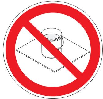
**Metalleimer sind stets zu erden:** Einen Erdungsdraht am Eimer anbringen. Ein Ende am Eimer und das andere Ende an eine wirksame Erdung wie z. B. ein Wasserrohr anbringen.
