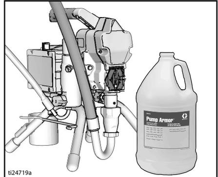
15. Limpie el pulverizador, la manguera y la pistola con un paño empapado en agua o esencias minerales.
