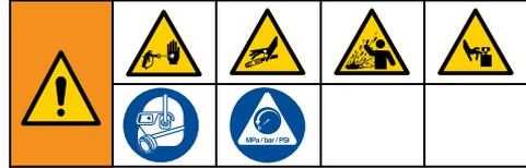
Este equipo seguirá presurizado hasta que se alivie manualmente la presión. Para ayudar a evitar lesiones graves por fluido presurizado, como la inyección en la piel, salpicaduras de fluido y las ocasionadas por piezas en movimiento, siga el **Procedimiento de descompresión** cuando deje de pulverizar y antes de limpiar, revisar o realizar tareas de mantenimiento en el equipo.
