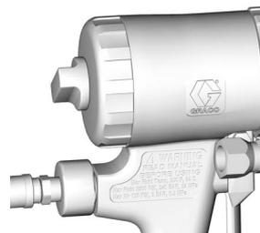
8. Débrancher la conduite d'air du pistolet et retirer le collecteur de fluide du pistolet.
