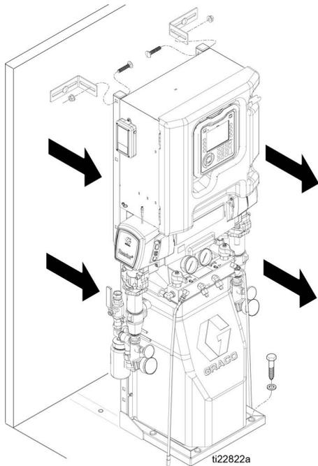
9. 卸下两个螺栓和螺母，然后向后合拢电气外壳。
