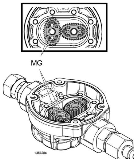
**注意：**带有磁铁 (MG) 的齿轮必须安装在左侧，否则流量计将无法工作。安装齿轮，如图所示。
