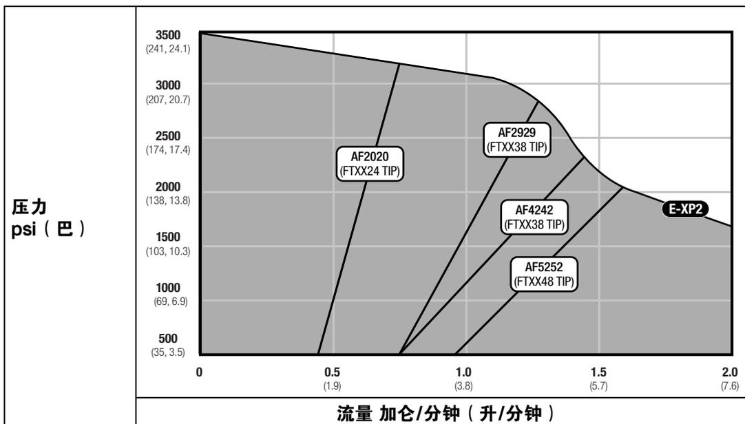
表 3 Fusion 机械净化，圆形喷型
