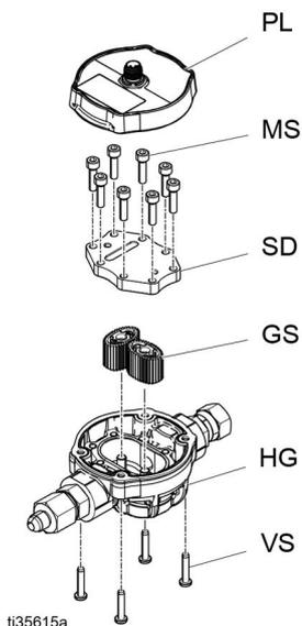
6. 拆下八颗螺钉 (MS)，拆下金属帽 (SD)。
