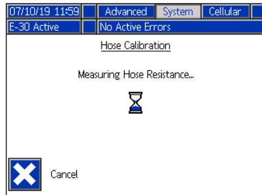
**注意：**如果在执行校准程序之前加热了软管，则系统将等待最多五分钟，以使电线温度达到平衡。
