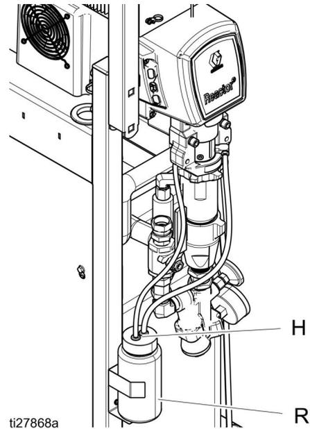
7. 通过在配比泵正常操作期间感觉回流管的脉动情况，确认 ISO 泵正在正常运行。
