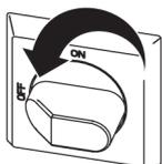
7. 将两个进料泵都关闭。关闭所有流体供给阀。
