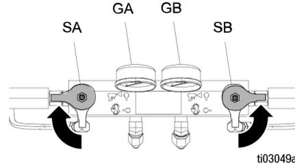
将歧管从喷枪上取下，通过流体在歧管内循环，冲洗整个系统。
