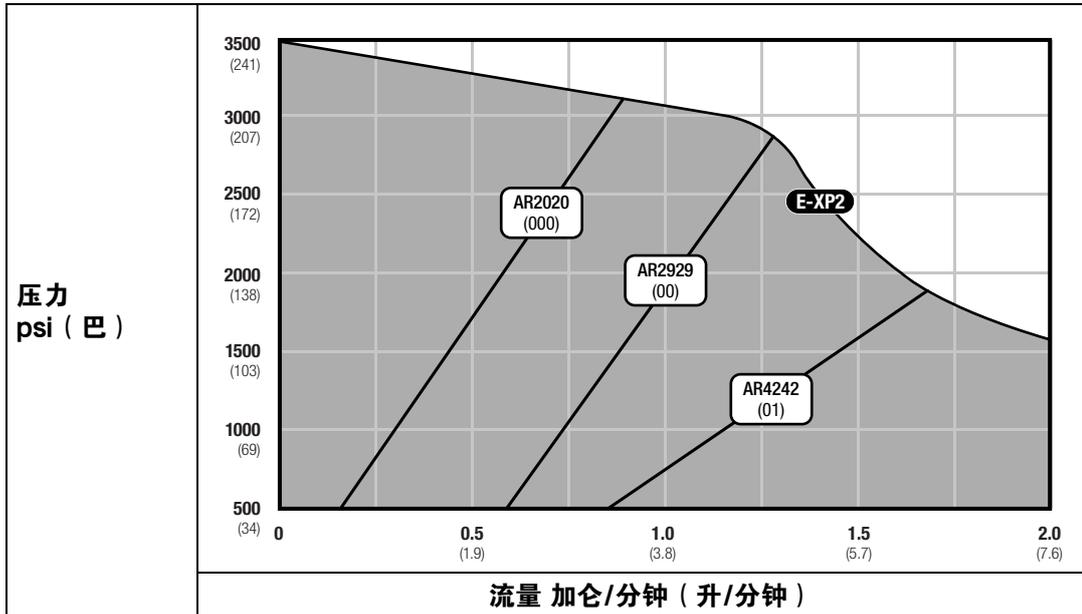
表 2 Fusion 空气净化，扁平喷型
