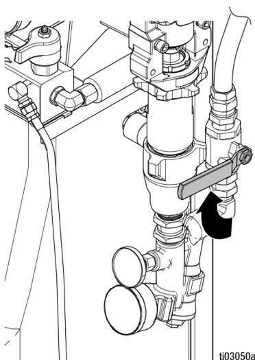
8. 将流体引到废液桶或供料桶内。将泄压/喷涂阀
