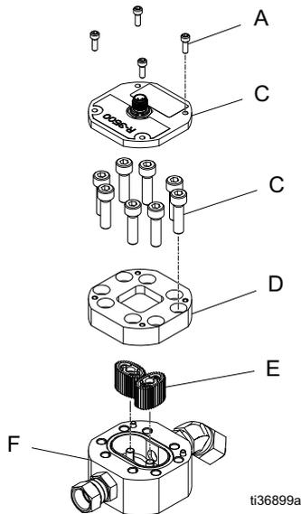
6. 拆下八颗螺钉 (C)，拆下金属帽 (D)。
