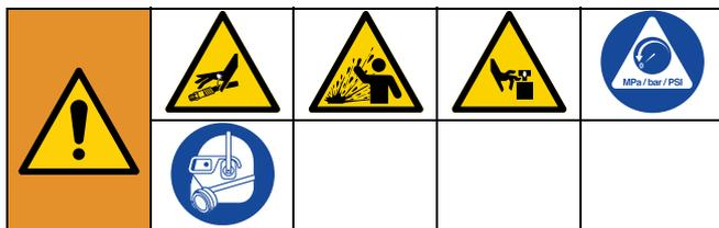
本设备在手动释放压力之前一直处于加压状态。为防止加压流体造成严重伤害，如喷射到皮肤、流体溅泼和部件移动，停止喷涂时和清洗、检查或维修设备前，请按照泄压步骤执行。
