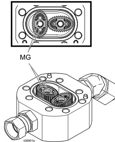
**注意：**带有磁铁 (G) 的齿轮必须安装在左侧，否则流量计将无法工作。安装齿轮，如图所示。
