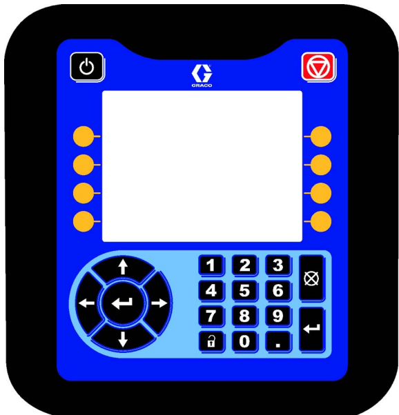
OBRÁZEK 5: Přední pohled na modul ADM
