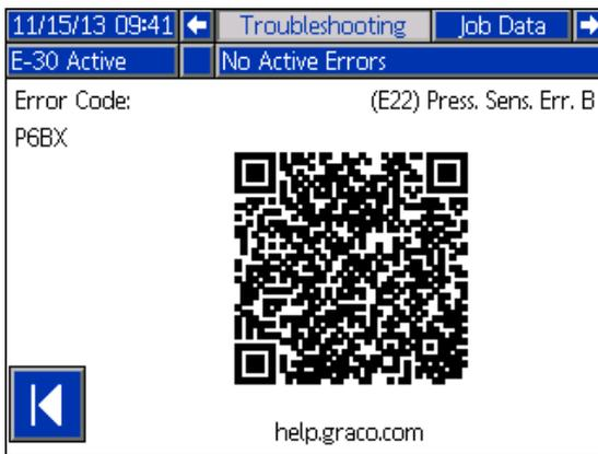
Um schnell auf die Online-Hilfe für einen Fehlercode zugreifen zu können, kann der angezeigte QR-Code mit einem Smartphone gescannt werden. Sie können auch zu [help.graco.com](http://help.graco.com) gehen und dort nach dem Fehlercode suchen, um die zugehörige Online-Hilfe aufzurufen.
