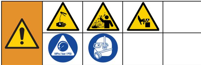
本设备在手动释放压力之前一直处于加压状态。为了防止带压流体造成严重伤害，例如皮肤注射、流体喷射或是部件移动，当您停止作业后，或是在清洁、检查、或是保养设备之前，请遵循泄压流程。
