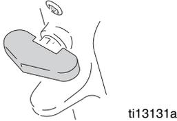
2. Mettre l'interrupteur principal sur OFF (arrêt) et tournez le régulateur complètement à gauche.
