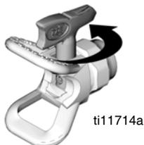
3. Tourner la buse en position SPRAY (pulvérisation). Mettre la pompe EN MARCHÉ (ON). Tester la forme du jet.
